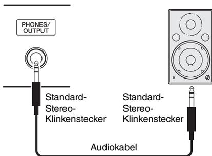
Die PHONES/OUTPUT-Buchse fungiert auch als externer Ausgang. Sie können an der Buchse PHONES/OUTPUT einen Keyboard-Verstärker, eine Stereoanlage, ein Mischpult, ein Bandaufzeichnungsgerät oder ein anderes Audiogerät für Line-Pegel (Leitungspegel) anschließen, um das Ausgangssignal des Instruments an dieses Gerät zu schicken.
