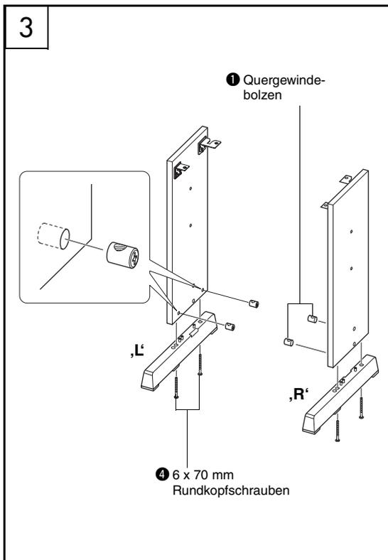
Bringen Sie die Standfüße „L“ (Links) und „R“ (Rechts) unten an den Seitenplatten an. Verwenden Sie dazu die Schrauben ④. Die Bezeichnungen „L“ (Links) und „R“ (Rechts) befinden sich auf den oberen Flächen der Standfüße. Wenn Sie Probleme haben, die Schrauben einzudrehen, verwenden Sie einen Schraubendreher, um die Quergewindebolzen so auszurichten, dass die Gewindeöffnung in Richtung der Standfüße weist.
